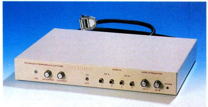
Video Blender: Das Multivideoeffektgerät bietet ein Genlock und eine Blue-Box, um Videobilder zu mischen.
