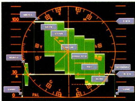
Horizontaloszillogramm Sync- und Burstsignal sowie die Farbbalken einer Videosignalzeile
