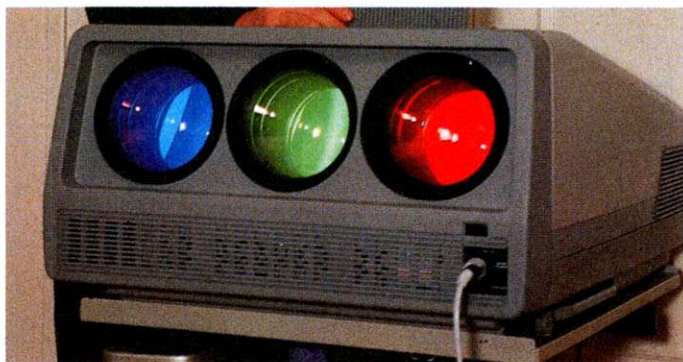
Sony VPH 1271 Der Großbildprojektor ist wegen geringer Leuchtkraft nur für abgedunkelte Räume geeignet
